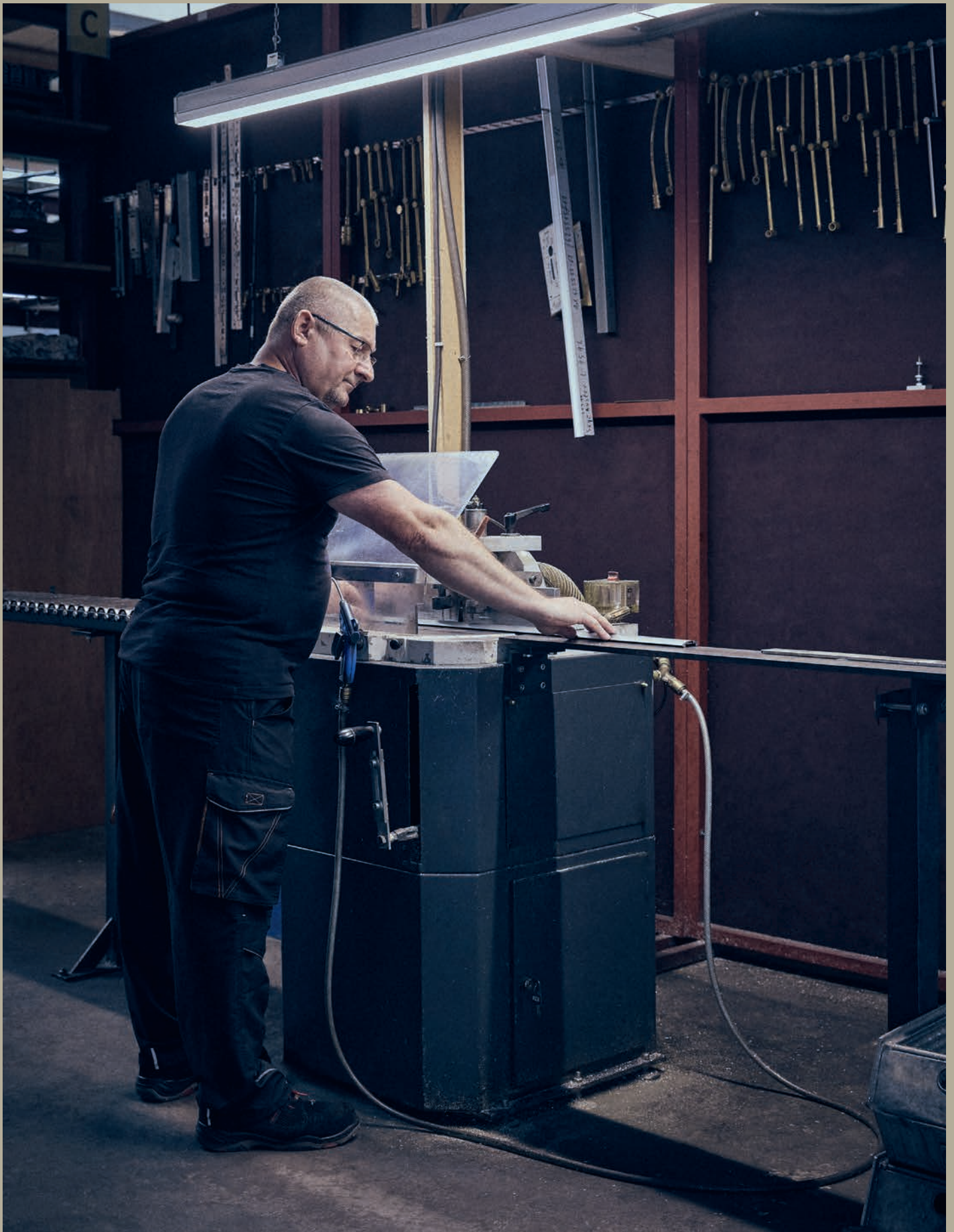
Zuschnitt von Aluminiumprofilen. Im Bild das Profil der Epsilon-Pendelleuchte .
